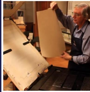
**Drucken:** Der Setzrahmen mit den Lettern wurde unter die Presse geschoben. Durch das Herunterdrücken des Druckbalkens der Presse wurde gleichmäßiger Druck auf das Papier ausgeübt, sodass die Tinte von den Lettern auf das Papier übertragen wurde.
